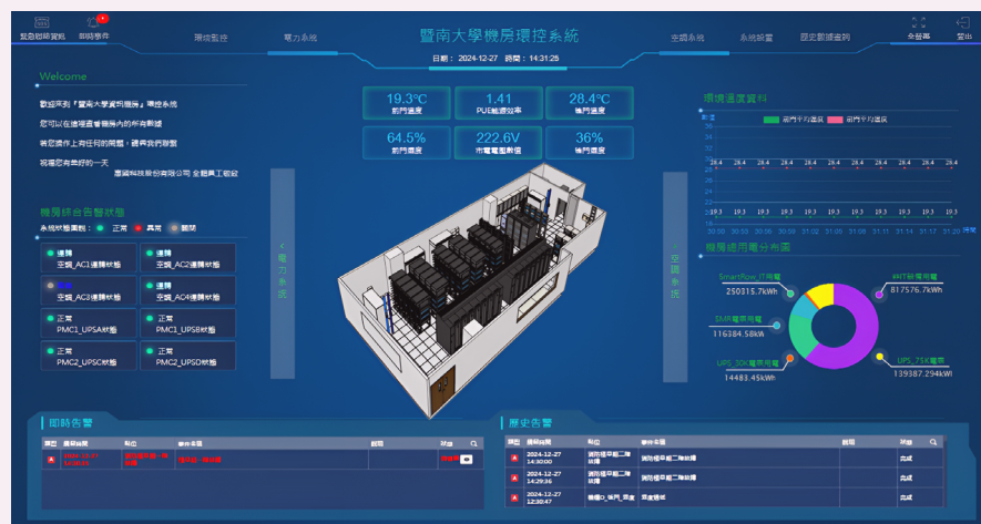
圖 2.5-2、即時監控機房溫溼度、電力及 PUE 能源效率
