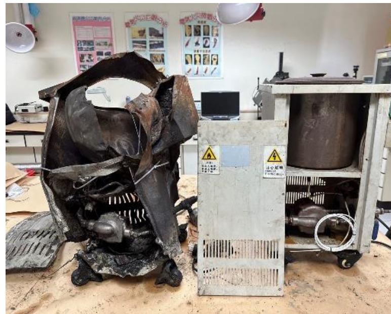
火調小組拼湊爆裂的油浴機（左）與同款油浴機的比對
