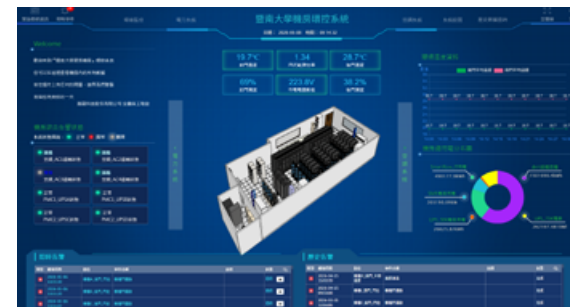
▲ 即時監控機房溫溼度、電力及 PUE 能源效率
